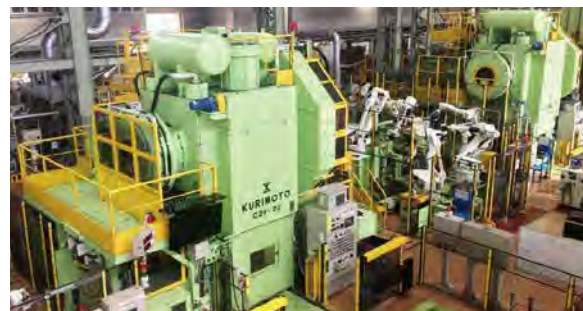
▲新たに導入したリングギヤ製造用鍛造機
